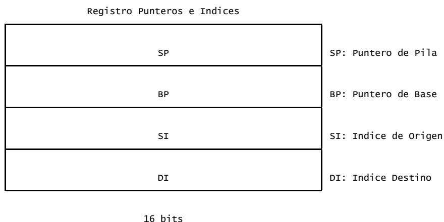
Los registros Índices SI y DI y los registros Punteros SP y BP guardan los valores de desplazamiento empleados para el acceso a determinadas posiciones de memoria. Una característica importante de los 4 registros es que se pueden usar operaciones aritméticas y lógicas de modo que los valores de desplazamiento que almacenan
