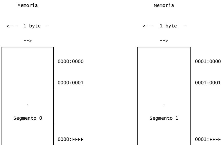
La porción del segmento es siempre de 16 bits. La porción del desplazamiento es de 16 y 32 bits. En modo real el valor del segmento es una dirección física que tiene una relación aritmética con el desplazamiento.
