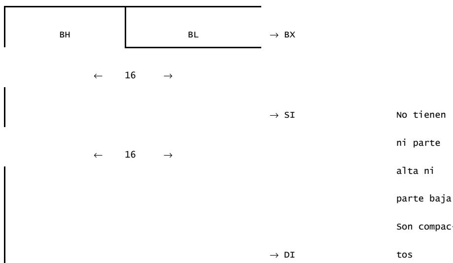
Otro registro que se puede usar como BX, SI y DI es el registro de puntero de base BP. Al igual que en SI y DI no se puede acceder por separado a los 2 bytes de mayor y menor peso. Pero la mayor diferencia es que por defecto se usa el registro de segmento SS para completar la dirección de 20 bits.
