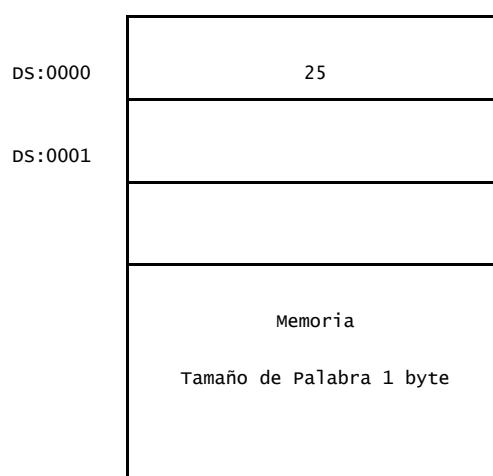
Aunque así podemos acceder a cualquier posición de memoria, en el segmento apuntado por DS, a menudo, nos interesa acceder a la posición de memoria indicada por el contenido de un registro. Por omisión se asume que la dirección de un operando está en el segmento de datos y el registro de segmento a emplear es DS. Con el desplazamiento almacenado en BX, SI o DI.
